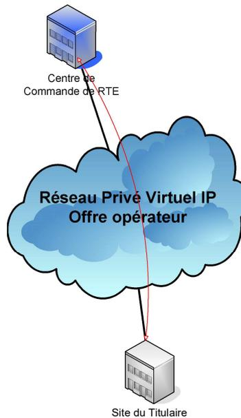
Cette architecture technique achemine les paquets IP et les protocoles associés (ICMP, TCP, UDP) en disposant de l'ensemble des mécanismes de Qualité de Services requis (décrits au §5.2.5).
