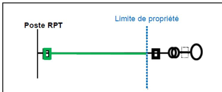
SCHEMA 1 : Raccordement sur un poste de RPT par une liaison intégrée au RPT
