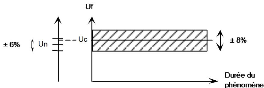
Pour le 150 kV, la Tension d'Alimentation Déclarée ( $U_c$ ) est située dans une plage de  $\pm 7\%$  autour de la Tension Nominale ( $U_n$ ). L'amplitude de la Tension de Fourniture ( $U_f$ ) peut varier de  $\pm 10\%$  autour de la Tension d'Alimentation Déclarée, sans toutefois dépasser 170 kV (tension maximale liée au dimensionnement des matériels).
